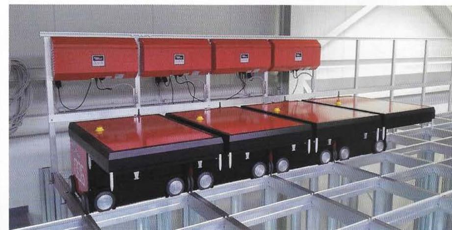
02 Bei zu geringer Batteriekapazität fahren die Roboter selbstständig zur Ladestation am Rand des Fahrschienensystems (Grid)
