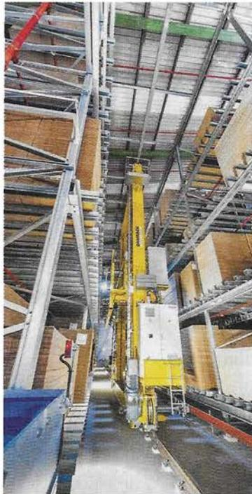
Die zwei Regalbediengeräte (RBG) sind mit jeweils 11 Teleskopgabelzinken zur Ladungsaufnahme ausgestattet. Die Gabelzinken können je nach Größe der Packeinheit entweder gleichzeitig oder getrennt voneinander ausfahren.
