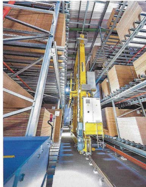
Blick in die Gasse eines Hochregallagers für Wellpappenformate.
